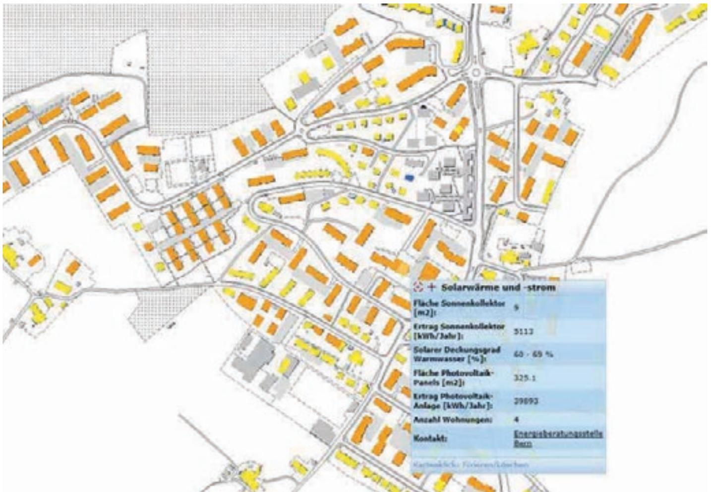
Ausschnitt aus der Karte «Solarwärme-Solarstrom» mit einer Infobox zu einem Gebäude. Die unterschiedlichen Farben zeigen die verschiedenen solaren Deckungsgrade für das Warmwasser.
