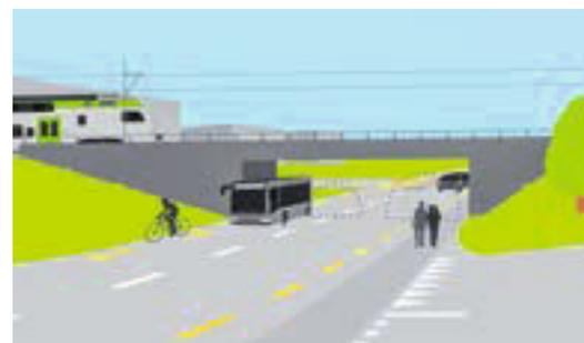
*Der Neubau der Unterführung Kirchstrasse wird ein komplett anderes Bild ergeben. Bewusst unterbunden bleibt aber der Lastwagenverkehr – die maximale Durchfahrts Höhe wird gegenüber heute bloss um 40 cm auf 3.4 m erhöht, was für Bus und Feuerwehr reicht.*
