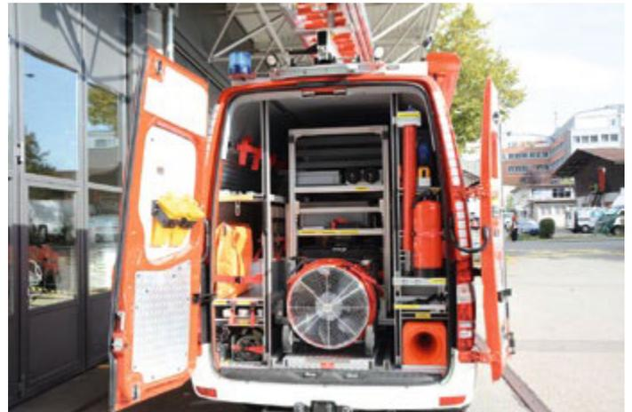
Ein Rollcontainer mit Führungsstützungsmaterial und ein Hochleistungslüfter: Im hinteren Teil des Fahrzeugs ist das Einsatzmaterial untergebracht.
