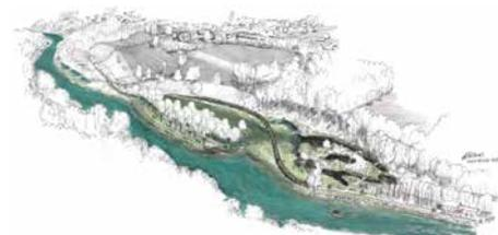
*Situation direkt nach Projektumsetzung: Am rechten Flussufer ist die Abwasserleitung in den Hang verlegt worden. Die Dämme sind im oberen Bereich entfernt, und die Aare ist dadurch eigendynamisch aufgeweitet worden. Der Weg führt jetzt über einen Steg entlang der aufgeweiteten Aare.*
